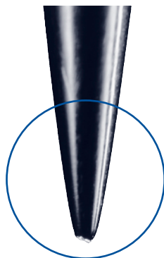
Darstellung einer beschädigten Nadelspitze
