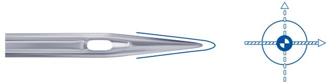
Die kleine Kugelspitze verdrängt die Gewebefäden, sticht so direkt in die Zwischenräume ein und vermeidet damit Gewebeschäden.
